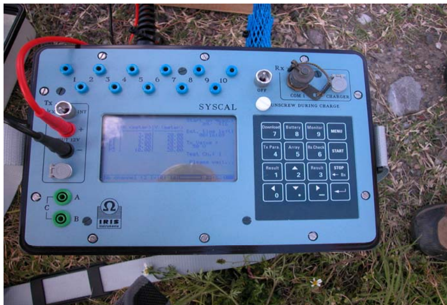
Figura 3.1. 1 Equipo para tomografía eléctrica.
