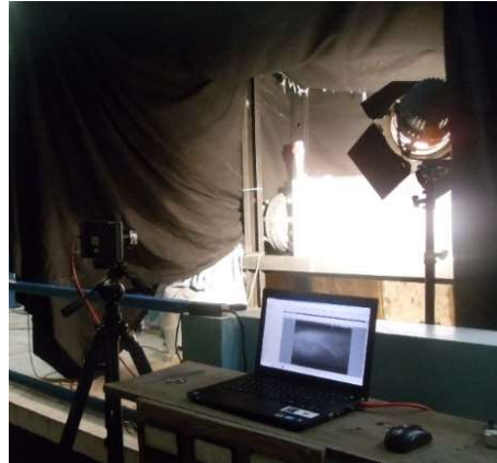
Figura 4.13. Configuración del espacio y toma de fotografías con la cámara FASTEC
