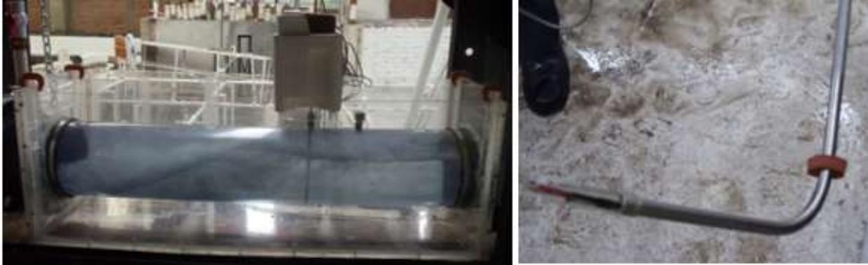
Figura 4.15. Sonda de conductividad de doble punta y su ubicación en el dispositivo
