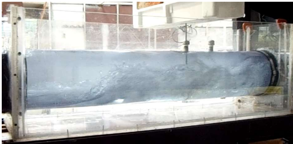
Figura 4.10. Tubería parcialmente llena hasta la descarga
