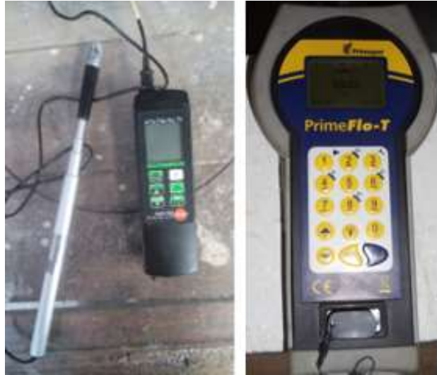
Figura 4.9. Izq. Anemómetro Modelo Testo 435. Der. Medidor de flujo, PrimeFlo-T
