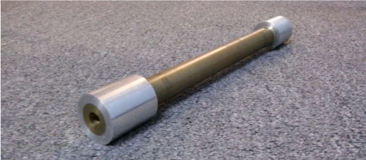
Figura 20. Fotografía del tubo de estrechamiento construido a partir de un buje de bronce de 1.25 cm de diámetro interno. Para adaptar la pieza al diámetro de los coples del tubo de transmisión, se incorporaron camisas de aluminio en los extremos.
