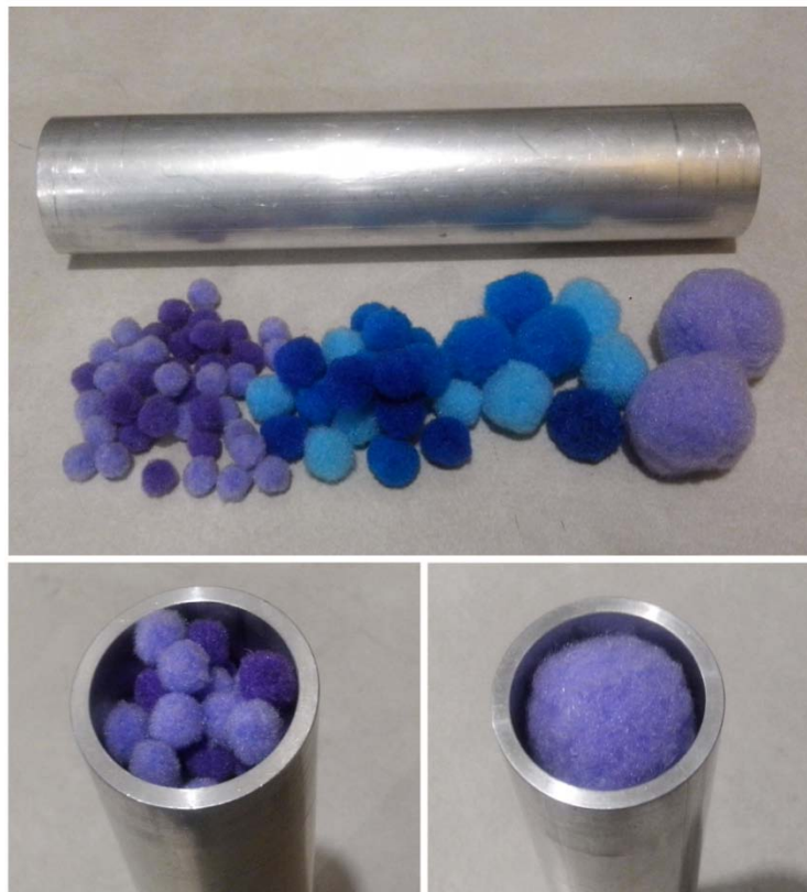
Figura 16. Bolitas de fibra de acrílico para la absorción progresiva del sonido en la terminación del tubo de transmisión.
