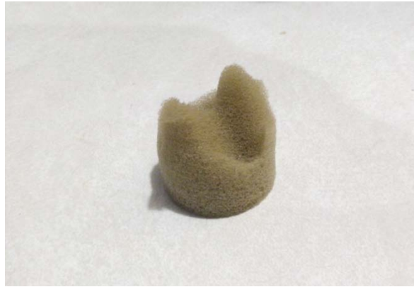
Figura 15. Espuma de poliuretano en forma de cuña utilizada para disminuir el tiempo de reverberación dentro del tubo y, en consecuencia, obtener una respuesta al impulso más corta.
