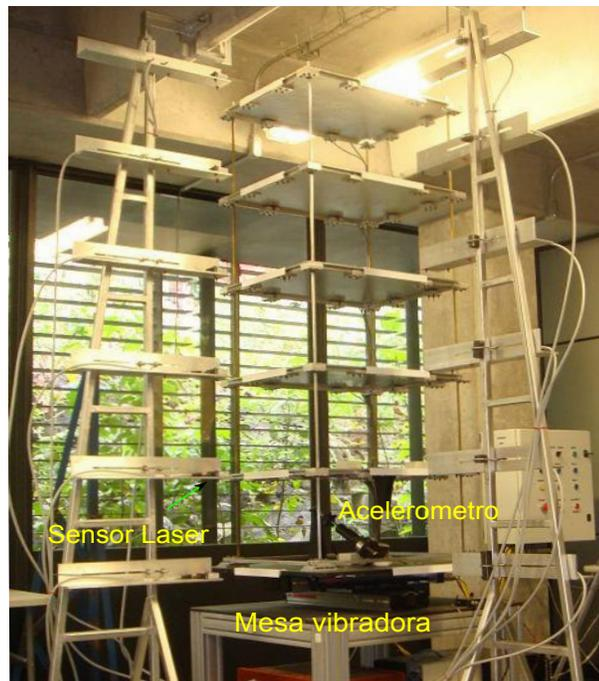
Figura 3.4: Edificio de cinco pisos escala reducida
