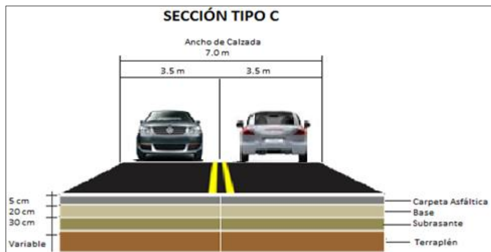
Figura 5.7 Sección tipo C. Fuente: Elaboración propia.
