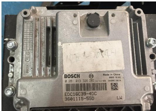
Fig. 5.11 ECU del motor diesel
