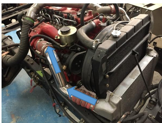
Fig. 5.5 Salida del flujo de aire del Intercooler
