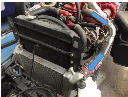
Fig. 5.4 Llegada del flujo de aire al Intercooler
