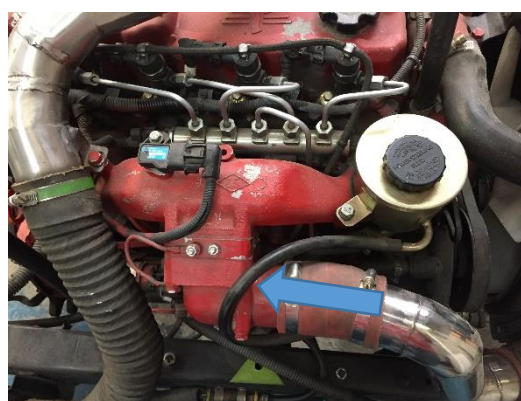
Fig. 5.6 Llegada del flujo de aire al Plenum
