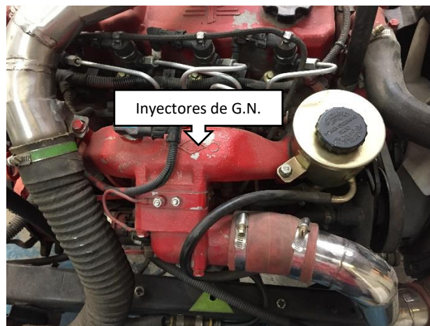
Fig. 5.10 Ubicación de los inyectores de gas natural
