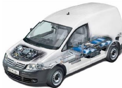
Fig. 3.2 Botellas de gas natural en un automóvil común
