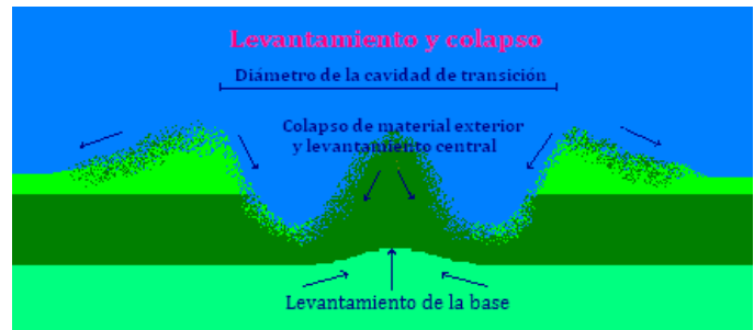
Figura 7. Levantamiento y colapso de la cavidad.
