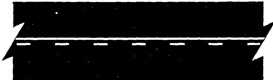
FIGURA 4.2 RAYA ADICIONAL CONTINUA PARA PROHIBIR EL REBASE
