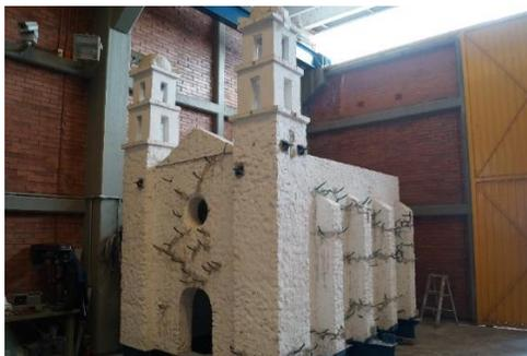
**Figura 2.1** Modelo MVTEMP-04 habilitado para ser inyectado con lechada.
