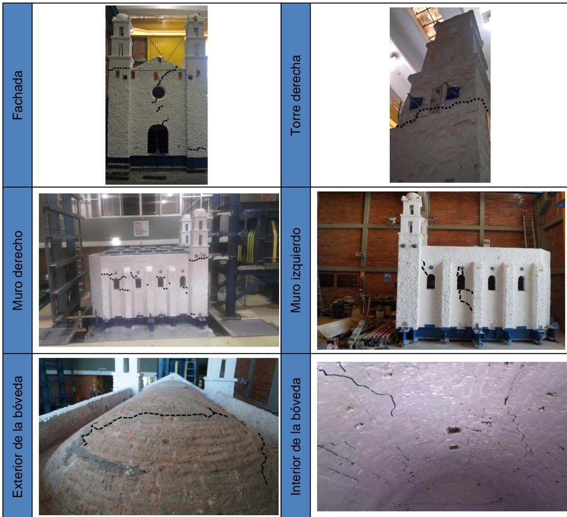
Figura 4.1 Principales daños en el modelo MVTEMP-04.
