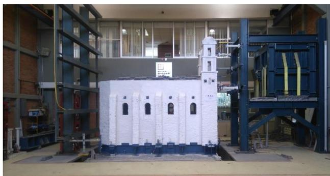
Figura 3.1 Orientación del modelo en la mesa vibradora.
