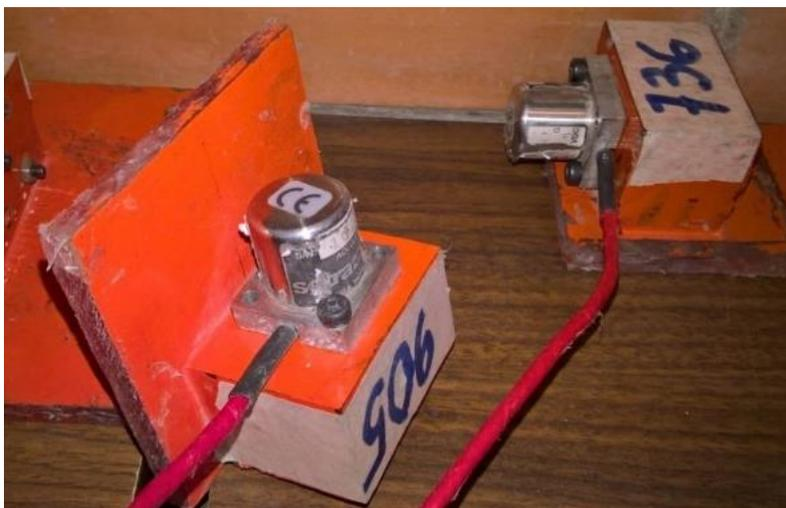
Figura 3.4 Acelerómetro tipo SETRA.
