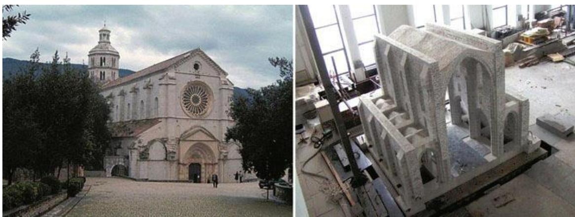
**Figura 1.6** Catedral de Fossanova Abey. Prototipo y modelo escala 1:5.5 (Shendova, et al., 2012).
