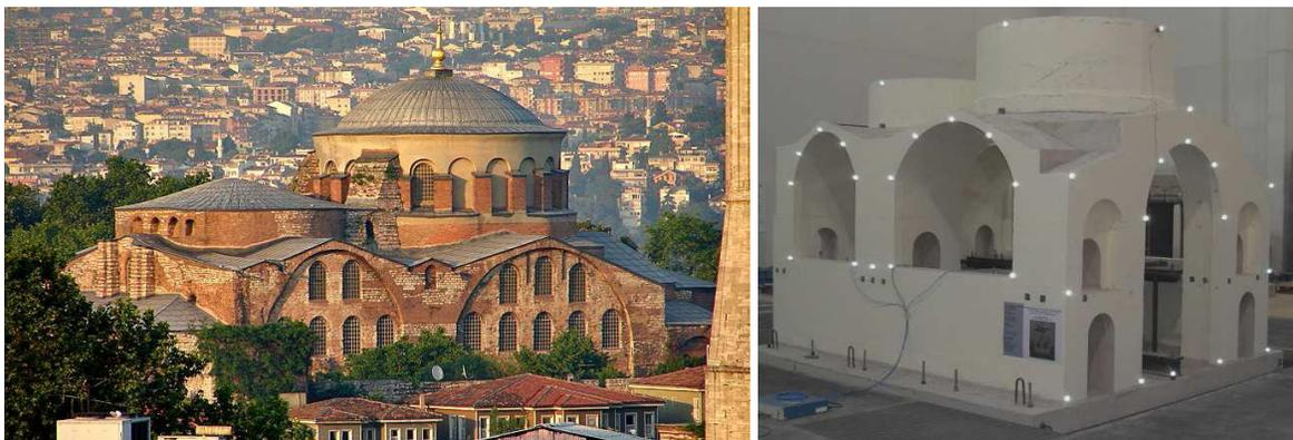
**Figura 1.8** Iglesia de Sta. Irene. Prototipo y modelo. Escala 1:10 (Crocì, et al., 2012).
