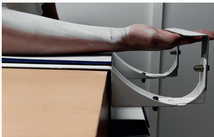
Figura 2.34: Alineación de la marca de referencia 3 con el borde del dispositivo de posicionamiento y posición inicial.
