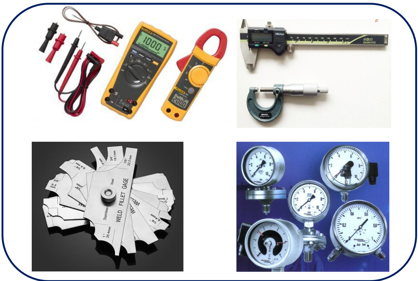
Imagen 2.1 Ejemplos de algunos instrumentos de medición o gages para medir características particulares en distintos procesos.
