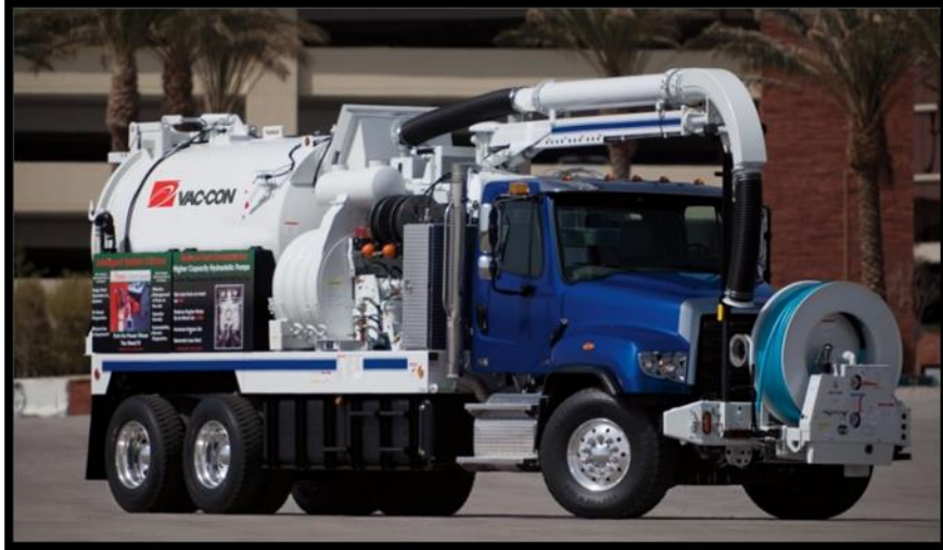
Figura 2.1. Equipo Hidroneumático Mixto VACCON de 12 yardas cúbicas. Fuente: www.vac-con.com
