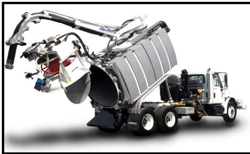
Figura 2.2. Equipo Hidroneumático Mixto Aquatech de 10 yardas cúbicas. Fuente: www.aquatechinc.com
