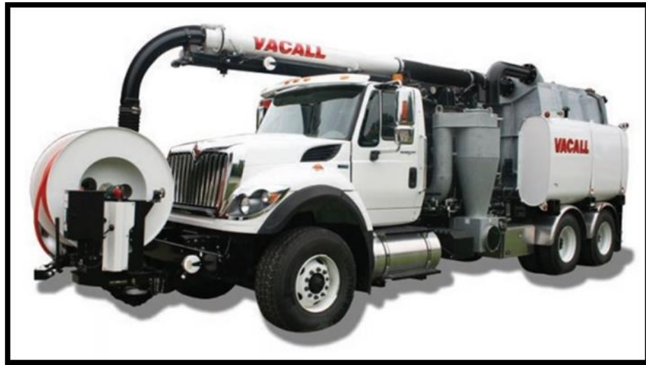
Figura 2.3. Equipo Hidroneumático Mixto Vacall de 6 yardas cúbicas. Fuente: www.vacall.com
