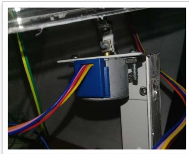
Figura 96. Motor colocado sobre el eje horizontal.
