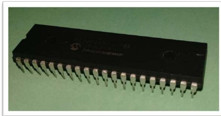
FIGURA 90. Microcontrolador PIC 18F4550.
