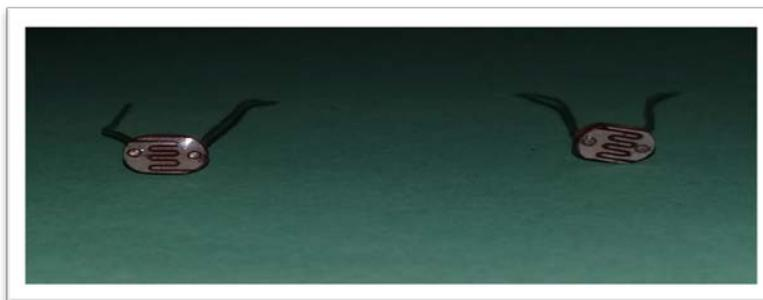
Figura 100. Fotorresistores del seguidor solar de dos ejes.
