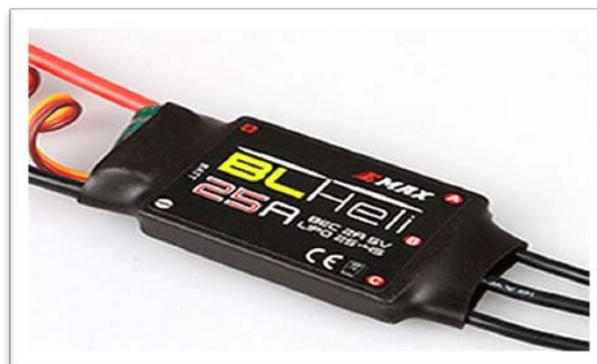
por defecto, detecta el 0% de empuje a 1,2ms y el 100% de empuje a 2ms. La Figura 116 muestra este dispositivo.
