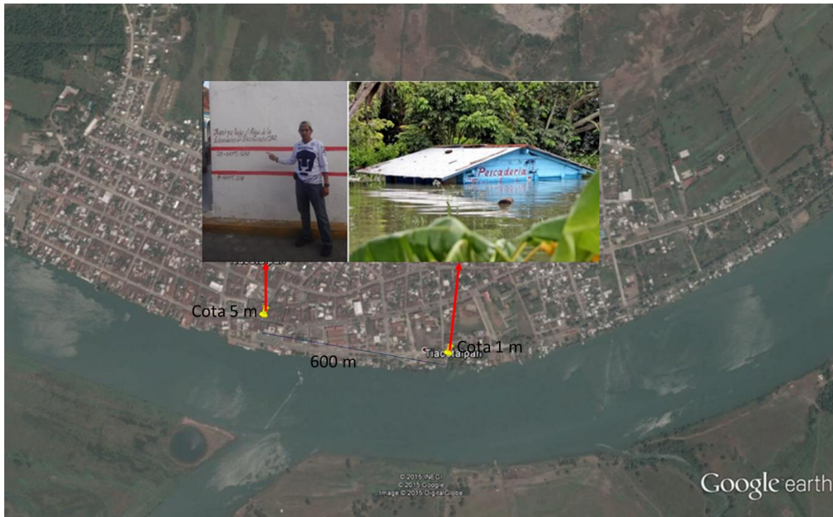
Figura 31. Vista de Google Earth de Tlacotalpan en 2015, en amarillo los puntos donde fue tomada la evidencia de niveles de agua alcanzados en la inundación de 2010.
