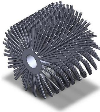
*Figura 4.1: modelo base original de tubo con aletas de espinas.*
