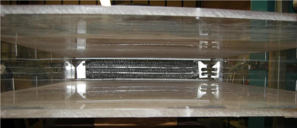
*Imagen 4.4. Vista de la entrada de flujo de aire caliente.*
