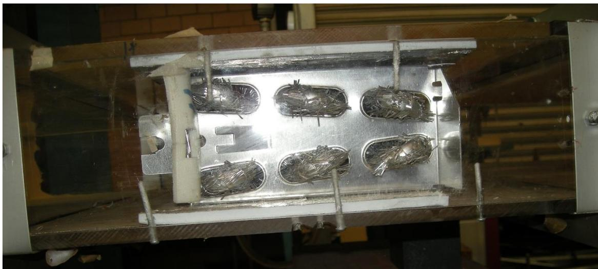
*Imagen 4.1. Arreglo de tubos aletados con reducción de sección transversal.*
