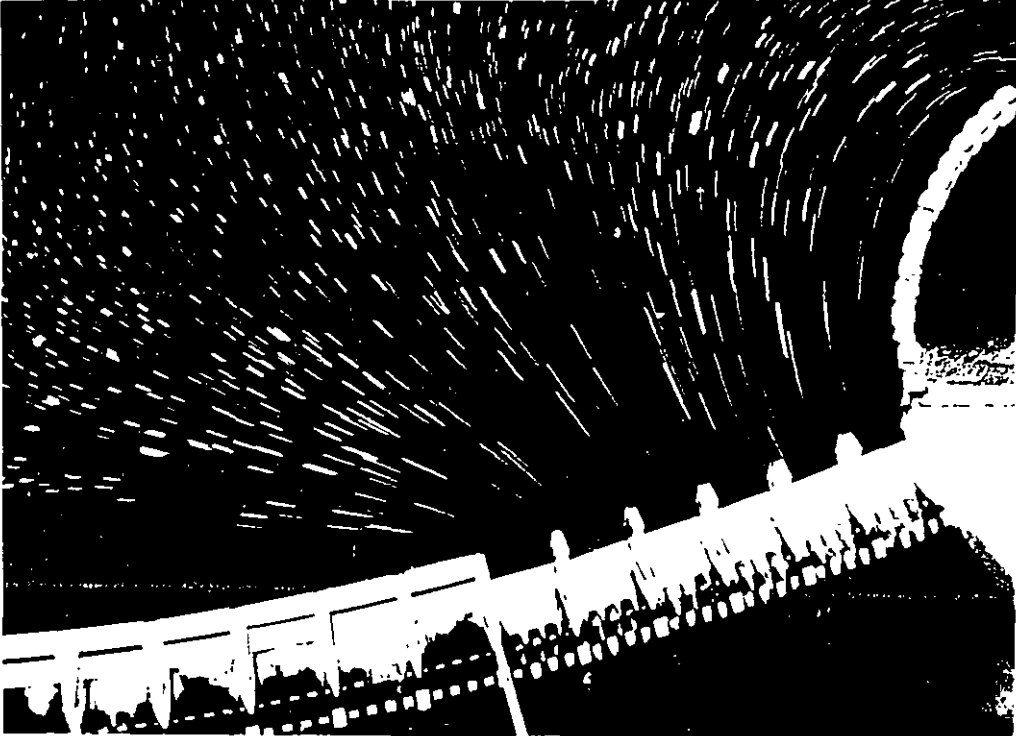
FIG. 7-2. En el modelo del aliviadero de presa construido y ensayado en St. Anthony Falls Hydraulic Laboratory, de la Universidad de Minnesota, U.S.A., las líneas de corriente se hacen visibles por los trazos que las partículas de confeti con que se espolvoreó la superficie del agua dejaron en la placa fotográfica en un segundo de exposición. Así se obtiene experimentalmente tanto la magnitud como la dirección de la velocidad. (Por cortesía de University of Minnesota.)
