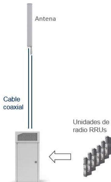
Figura 4.3 Unidades de radio al nivel del piso.
