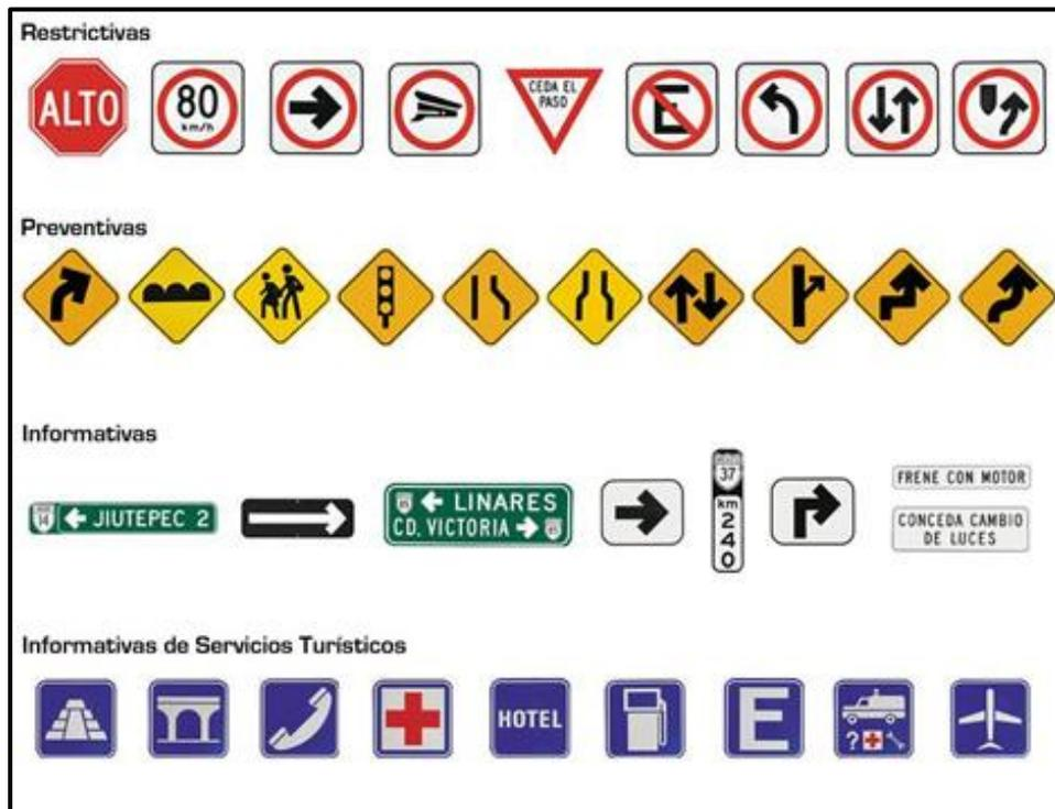
Figura 5.9. Ejemplo de Señalamientos Verticales.
