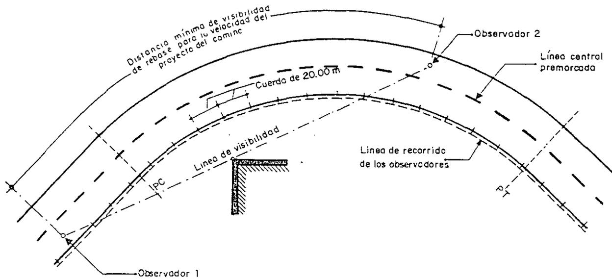
**FIGURA 2 PROCEDIMIENTO PARA UBICAR LOS LIMITES DE LOS TRAMOS DE REBASE PROHIBIDO EN CURVAS HORIZONTALES**
