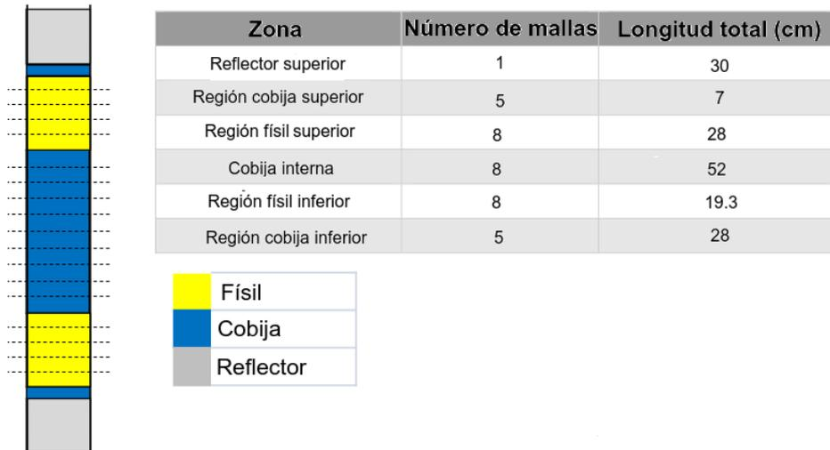
Figura 1.4: Configuración axial del RBWR usada por PARCS
