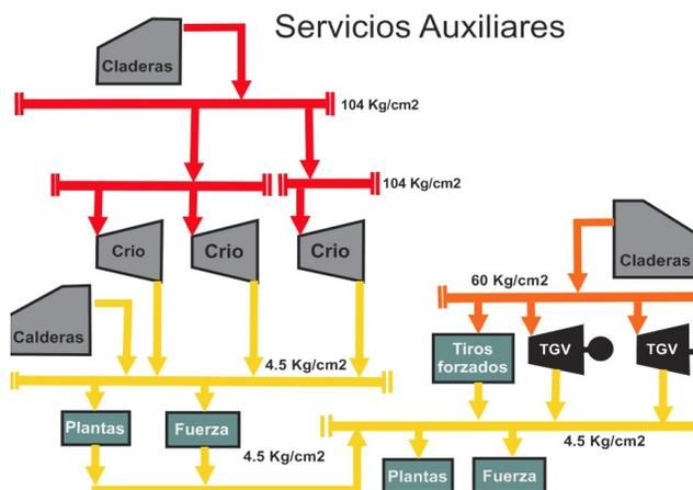
**Tabla 3. Esquema de cogeneración basado en turbinas de vapor**
