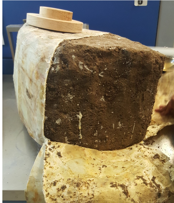
Figura A. 1 Descubriendo muestra cubica
