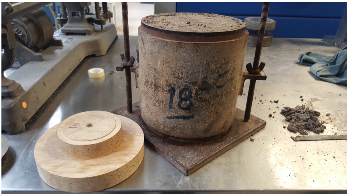
Figura A. 7 Se enrasa la muestra
