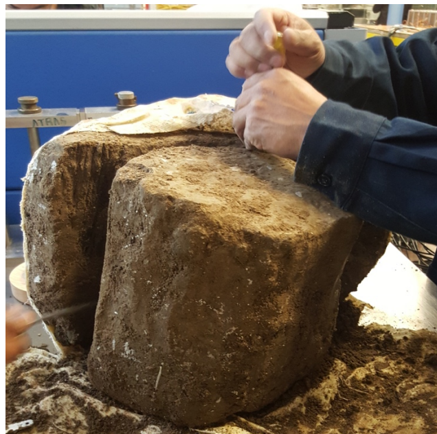
Figura A. 1 Descubriendo muestra cubica
