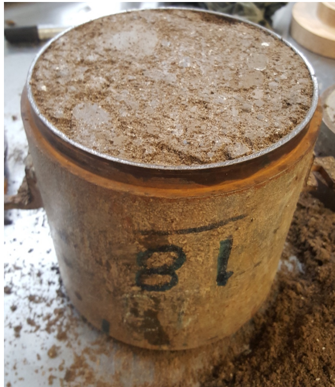
Figura A. 7 Se enrasa la muestra
