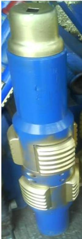
**Figura 4.7. Escariador para tubería de revestimiento.**
