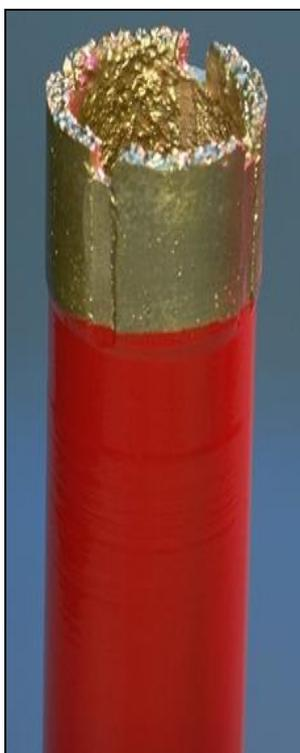
**Figura 4.13. Zapata lavadora plana.**
