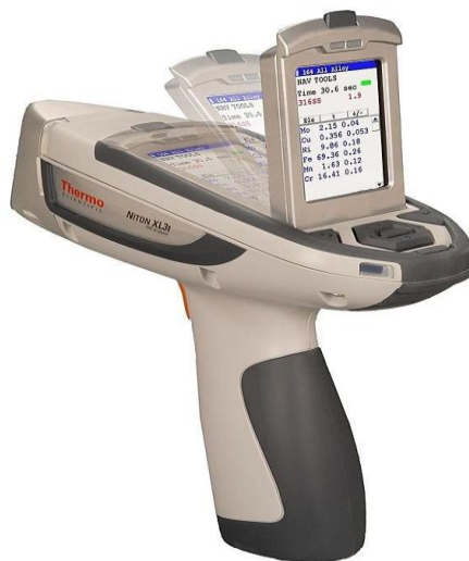
Figura. 3.4. Instrumento Portátil de Fluorescencia de rayos X Niton XL3t, (Tomada de http://www.panatec.net/ficha-analizadores-xl3t700ss.php , 1998).
