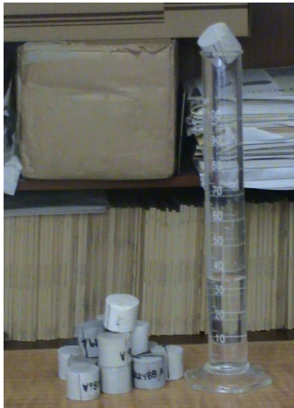
Figura. 3.3. Prueba de sumergencia para obtener el volumen de los tapones.
