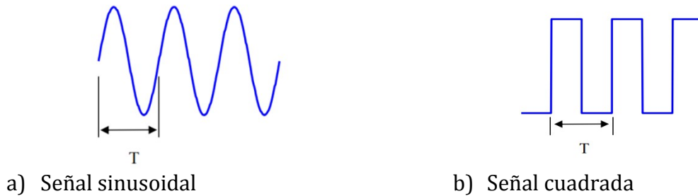
FIGURA 4.1.1.1 TIPOS DE SEÑALES PERIÓDICAS. REGULACIÓN, CONTROL Y PROTECCIÓN DE MÁQUINAS ELÉCTRICAS APUNTES DE LA ASIGNATURA CONVERTIDORES ELECTRÓNICOS DE POTENCIA DEPARTAMENTO DE INGENIERÍA ELÉCTRICA Y ENERGÉTICA UNIVERSIDAD DE CANTABRIA
