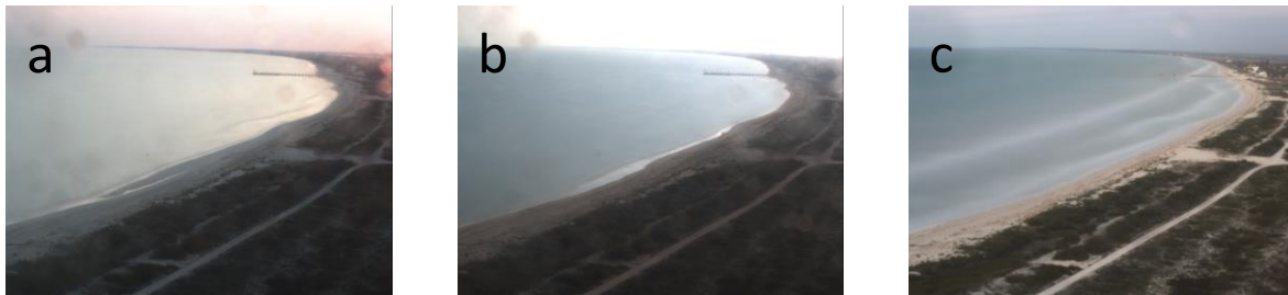
Figura 27. Comparación visual: a) posición de la línea de costa con la barra intermareal expuesta (25 de marzo de 2014, 12 horas UTC), b) posición de la línea de costa con la barra intermareal parcialmente sumergida (25 de marzo 2014, 13:30 horas UTC) c) posición de la línea de costa con la barra intermareal sumergida (25 de marzo de 2014, 23:30 horas UTC).
