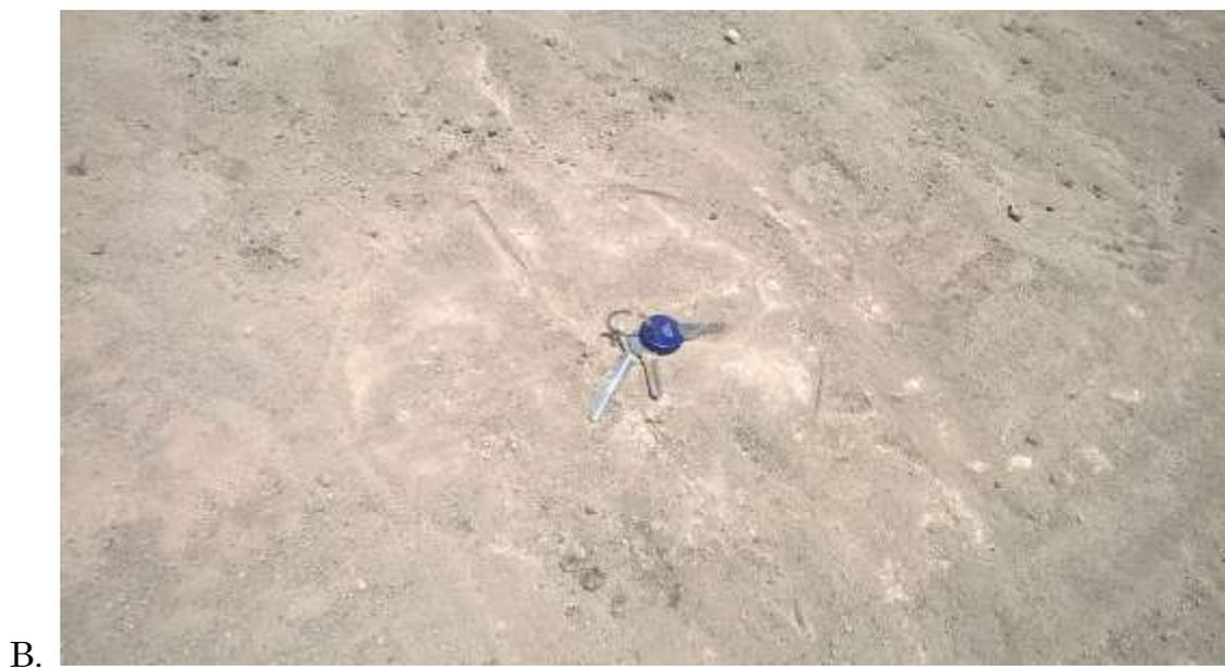
Imagen 13. Impresión de placa del FWD en (A) suelo natural y (B) en suelo mejorado con CaO.
