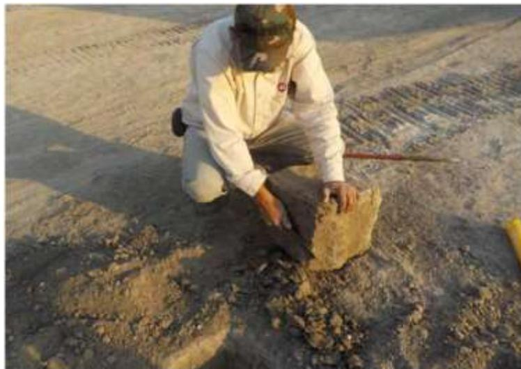
Imagen 10. Extracción de muestra de suelo inalterado.
