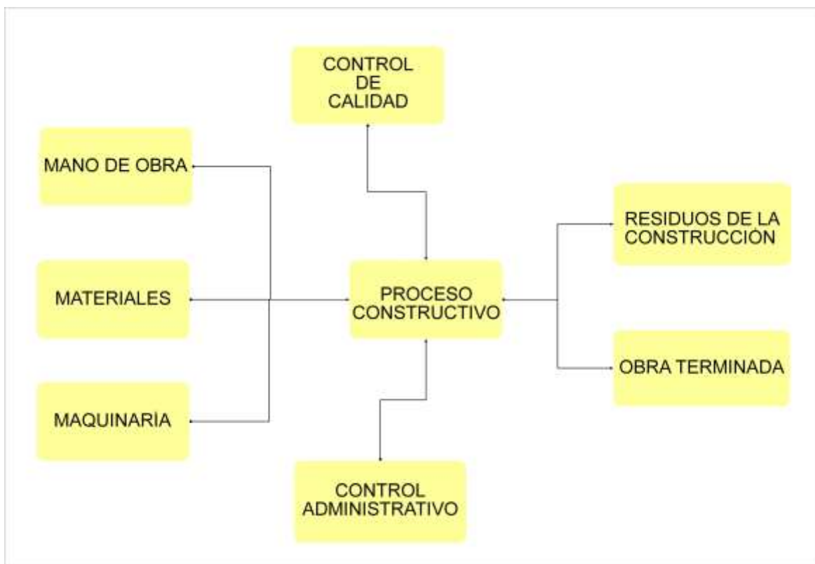
Figura 3-4 Diagrama del Proceso constructivo. Adaptado del diagrama original “Diagrama que representa el proceso constructivo”. Fuente: Introducción al Proceso Constructivo, página 42.
