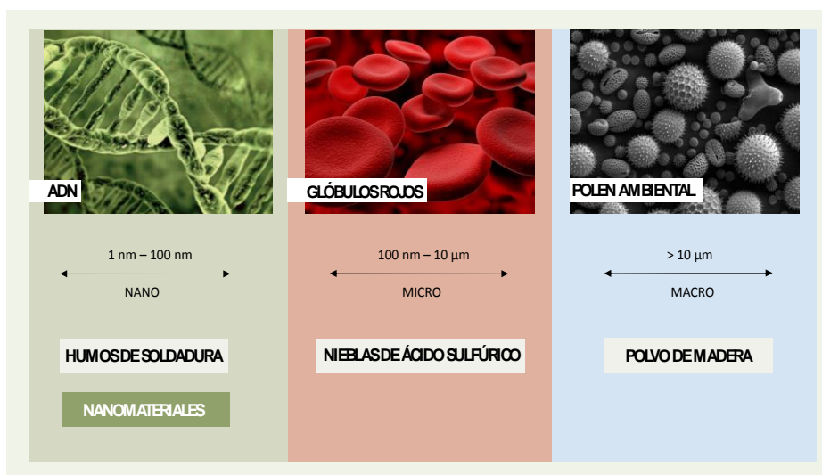
Figura 6. Esquema comparativo en las distintas escalas de tamaños (modificada de INSH, Instituto Nacional de Seguridad e Higiene en el Trabajo, 2015).
