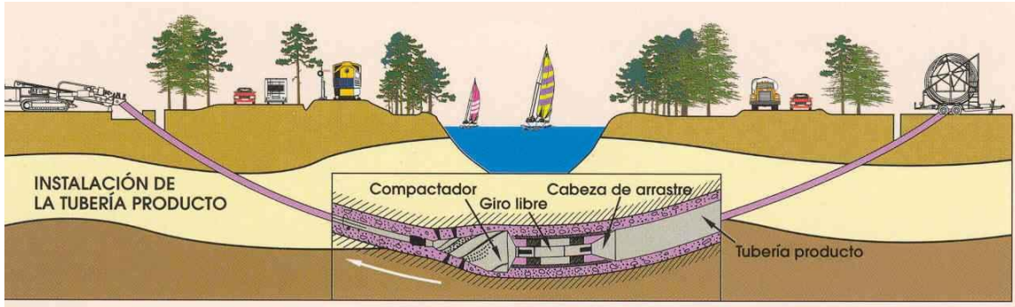
Figura 3. Instalación de la tubería
