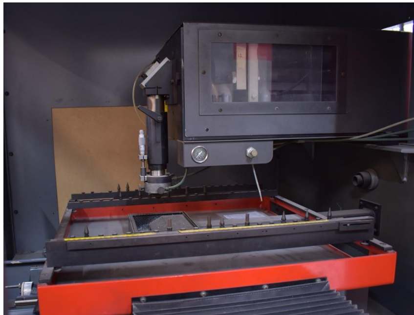
Fig. 1.2 Mesa de trabajo de la máquina. Se observa el obturador del láser.
