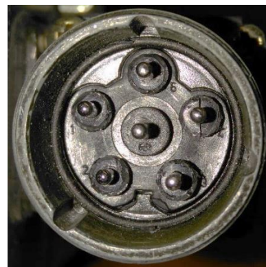
Fig. 2.3b Conector de alimentación del motor.
