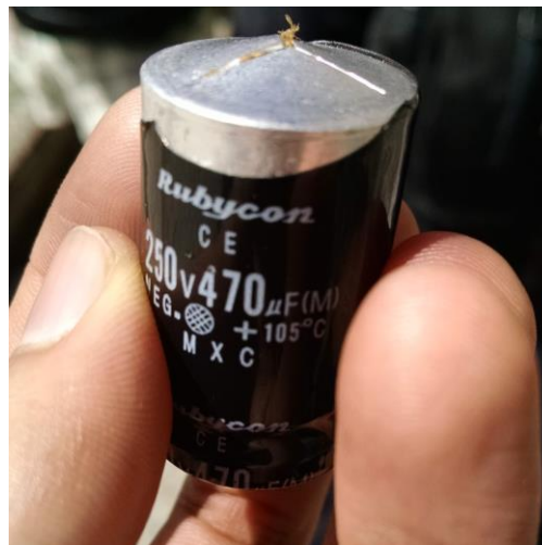
Fig. 2.13 Destrucción del capacitor.
