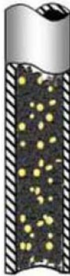
**Fig. 1.1 Flujo burbuja en una tubería vertical.**
