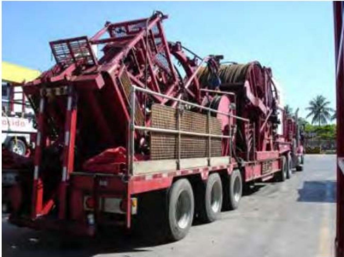
**Fig. 1.7** Equipo de tubería flexible.
