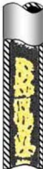
**Fig. 1.3 Flujo transición para tuberías verticales.**
