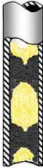
**Fig. 1.2 Flujo tapón o bache para tuberías verticales.**
