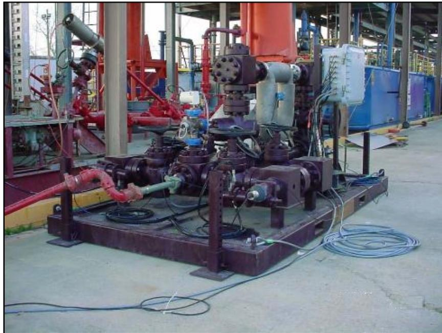
*Figura 2.52 El múltiple de estrangulamiento con medidor de flujo para Perforación Segura en operación.*
