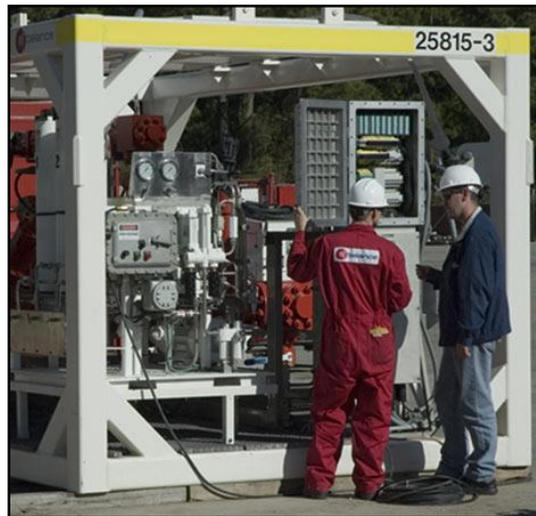
*Figura 2.12* Imagen que muestra la inspección del programador lógico programable montado en el múltiple de estrangulamiento del sistema DAPC. El programador contiene tecnología de control de seguridad crítica para manejar la operación del múltiple.
