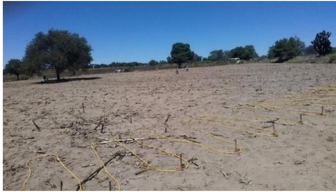
*Figura 39. Línea 1: se visualiza la disposición de los electrodos y cables del tendido de TRE.*
