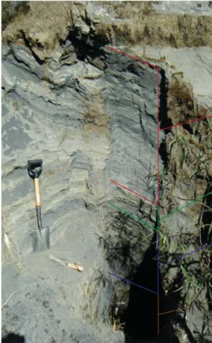
Figura 9. Fotografía del afloramiento (CHI-01), señalización de cada uno de los horizontes y su descripción física.
