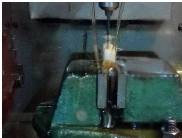
Fig. 4.3.3 Barrenado de la pieza "Caja tensor 1A" con una broca de 5/32 in.
