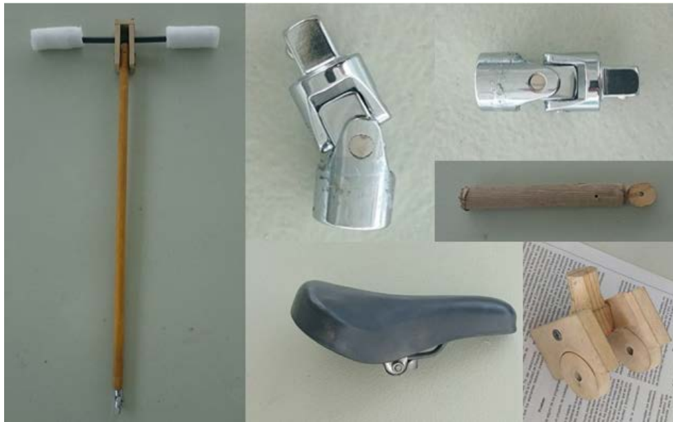
Figura 8.1. Piezas del prototipo (asiento, manubrio, articulación, barra superior de la tijera y base del asiento)
