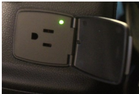
Ilustración 31. Cambio de diseño original (tapa abre lateral, conexiones rotadas 90°)
