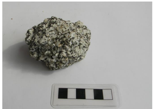
Figura 33. Muestra de mano correspondiente a la formación Los Barriles. Clasificada como arenisca conglomerática. Roca compuesta por cristales de biotita de hasta 5mm, cuarzo ~7mm y cristales de calcita de hasta 1cm. La roca está cementada por carbonatos.
