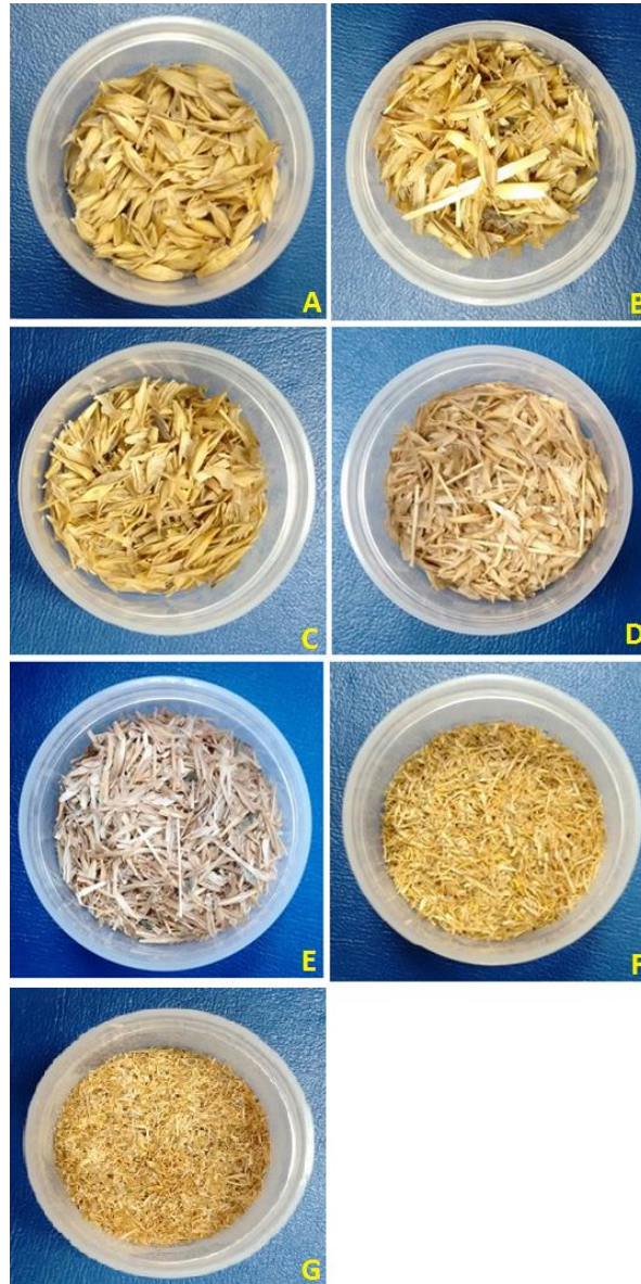
Figura 4.7 A) Muestras de cascarilla de cebada sin cribar, B) Malla # 8, C) Malla #10, D) Malla #12, E) Malla #14, F) Malla #30, G) Malla #35.
