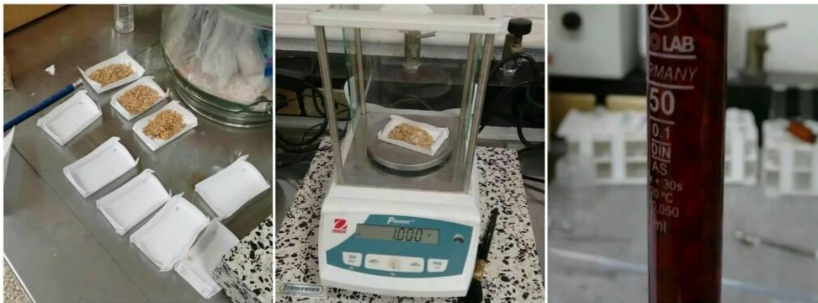
Figura 4.5 Proceso experimental de obtención de la densidad de la Cascarilla de Cebada.
