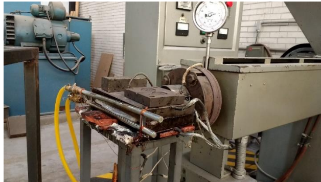
Figura 4.15 Montaje final dado de extrusión de láminas planas.
