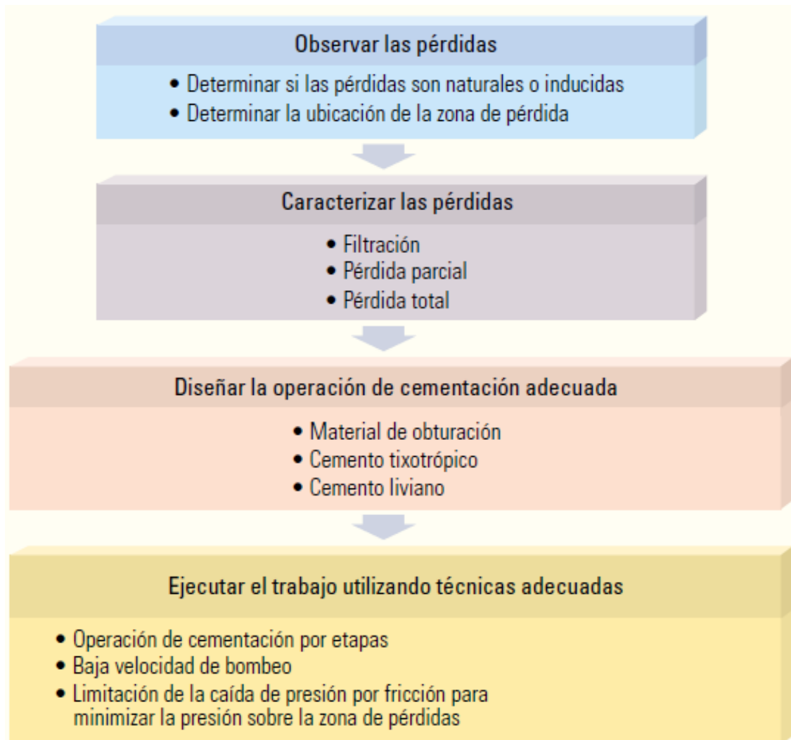
Figura 16. Secuencia de tareas para contrarrestar la pérdida de circulación durante la cementación. 11
