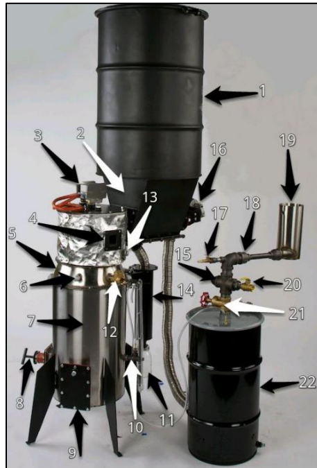
Figura 3.3 Equipo de gasificación GEK TOTTI
