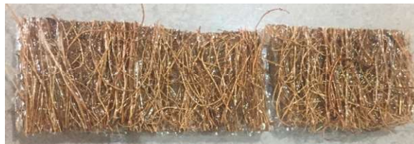
Figura 29. Probeta tipo epo trans fracturada
