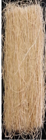
Figura 21. Probeta tipo coco long cortada con la ayuda de tijeras.
