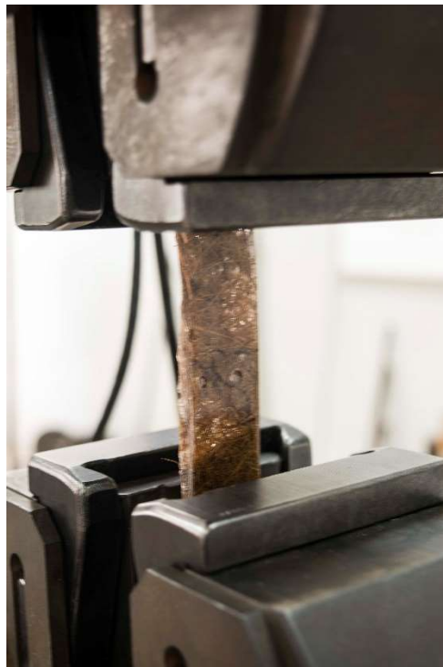
Figura 35. Probeta tipo epo ale sometida a ensayo de fatiga.
