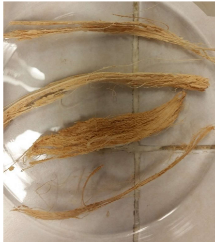
Figura 9. Aglomeración de fibras por celulosa.
