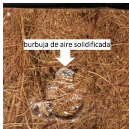
Figura 22. Burbujas de aire en una probeta.
