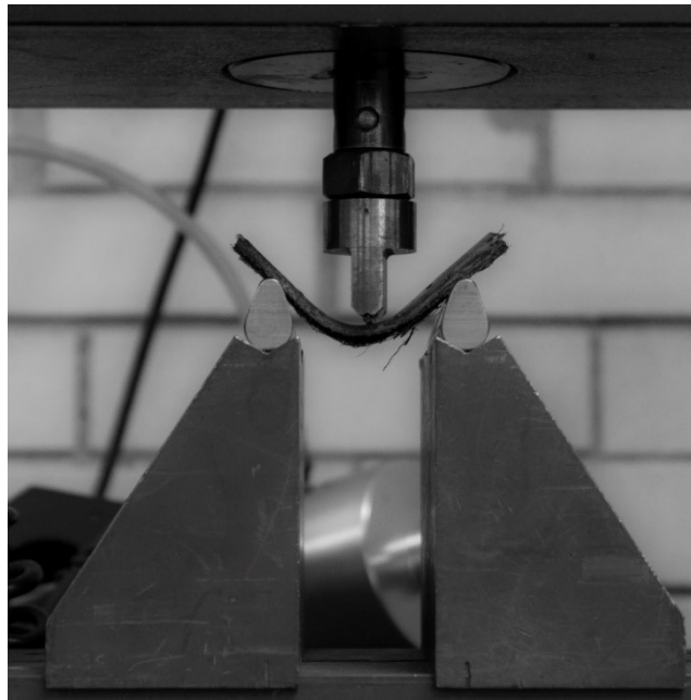
Figura 33. Probeta sometida a ensayo de flexión.
