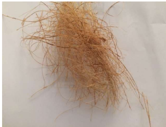
Figura 10. Fibra de coco desprendida de la celulosa
