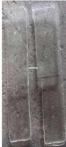
Figura 30. Probetas tipo epo Fracturadas.
