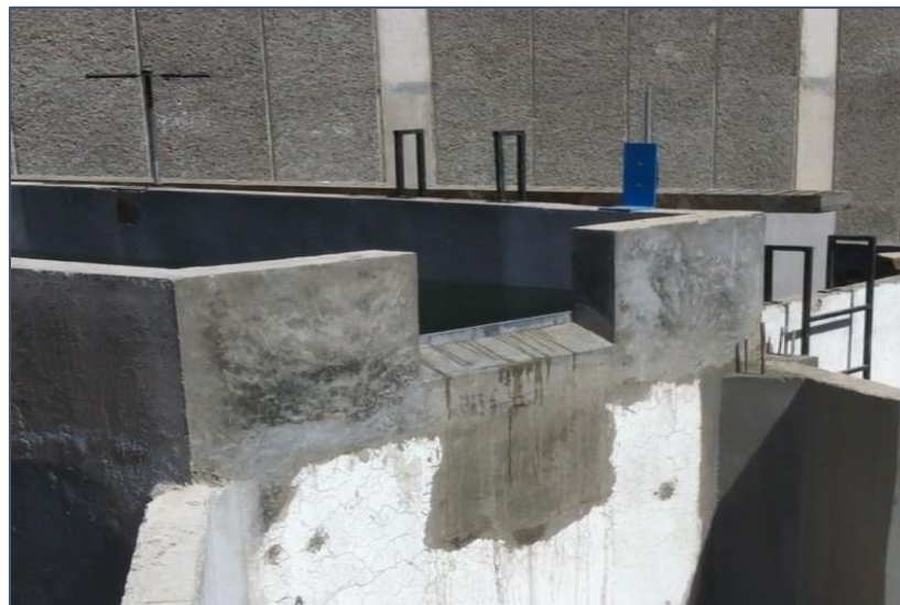
Figura 3.4.6. Vertedor rectangular utilizado en el modelo
