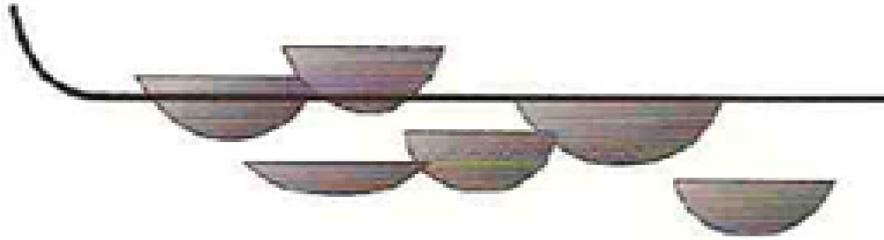
Figura 55. Pozo horizontal atravesando varias unidades de un yacimiento compartimentalizado
