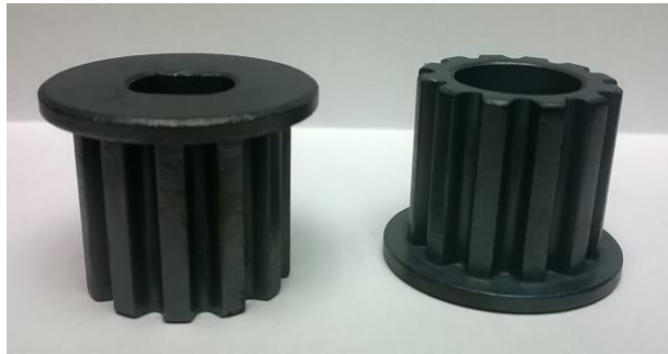
Fig. 17. Tratamiento de vaporizado en material de hierro F-0000-15 con los nuevos parámetros establecidos se genera una capa delgada de un óxido azul-gris (Magnetita Fe_3O_4 ), con este tratamiento se incrementa la dureza y la resistencia a la corrosión.
