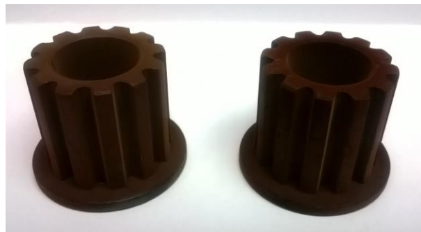
Fig. 16. Piezas del Inserto de Polea Inducida con tratamiento de vapor deficiente, se genera una capa de óxido férrico en la superficie. [Piezas producidas en Aleaciones Sinterizadas]
