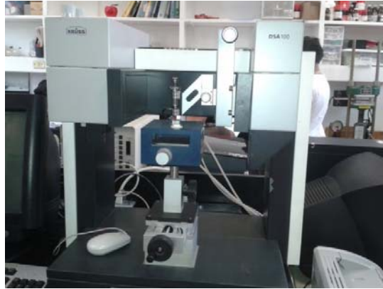
Figura 2.7.1. Aparato utilizado para la prueba de ángulo de contacto (marca: Kuss)
