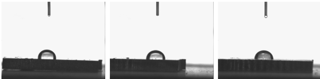
Figura 3.6. Ejemplos de la prueba de ángulo de contacto sobre deposiciones de Zr en el recubrimiento sol-gel en 2da dosis a diferentes tiempos.
