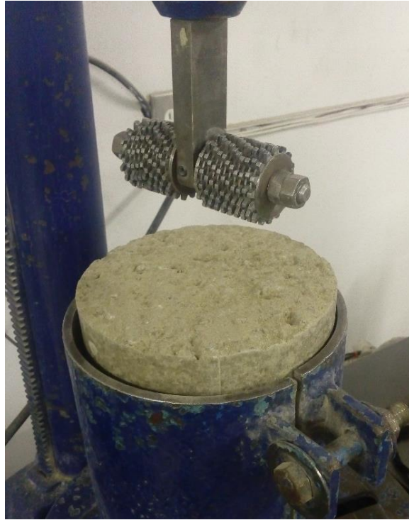
Fotografía 20 Espécimen de suelo-cemento colocado en la máquina de abrasión. Se aprecia la cortadora rotativa. Fotografía propia del autor.
