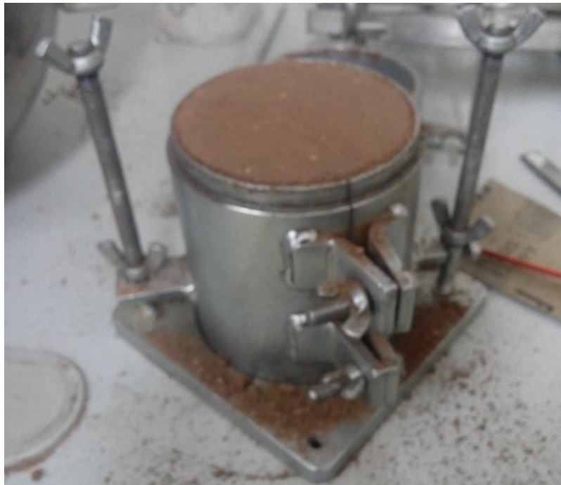
Fotografía 14 Especimen terminado de compactar, se ha retirado el anillo superior. (Fotografía tomada por el autor, 2016).
