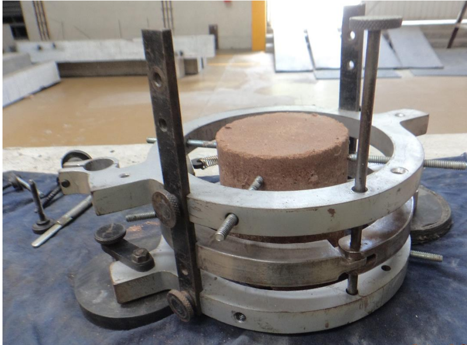
Fotografía 22 Anillos colocados en un espécimen de suelo-cemento para obtener el módulo elástico. (Fotografía tomada por el autor, 2016).
