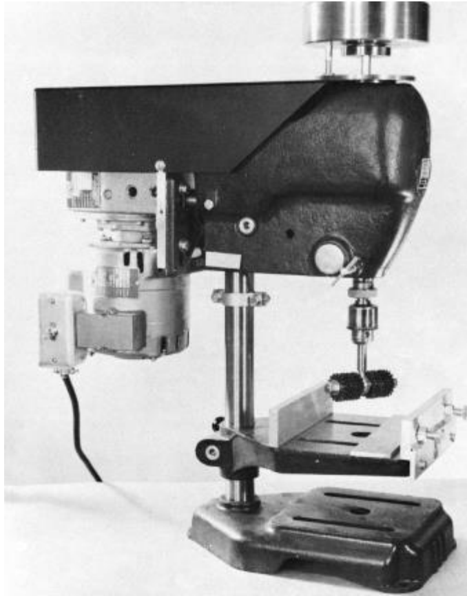
Fotografía 19 Máquina para prueba de abrasión. Obtenida de ASTM C944 “Standard Test Method for Abrasion Resistance of Concrete or Mortar Surfaces by the Rotating-Cutter Method”.
