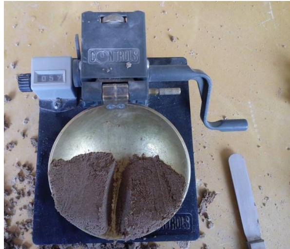
Fotografía 5 Formación de la ranura para la determinación del límite líquido en una muestra de suelo proveniente de Guanajuato. (Fotografía tomada por el autor, 2015).
