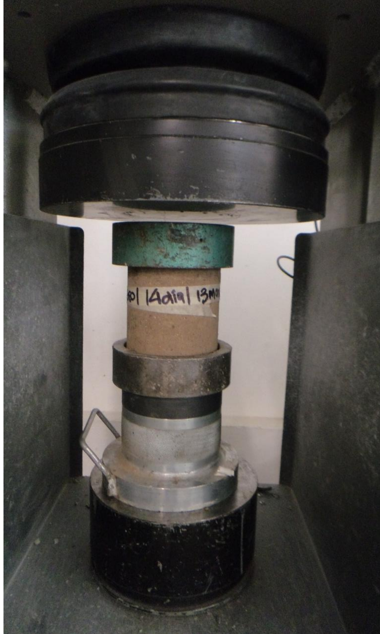
Fotografía 16 Ensayo a compresión de un cilindro de suelo-cemento a edad de 14 días. (Fotografía tomada por el autor, 2016).
