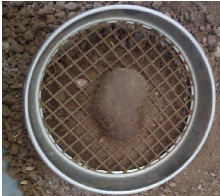
Fotografía 2 Retiro de material de sobre tamaño. (Fotografía tomada por el autor, 2016).
