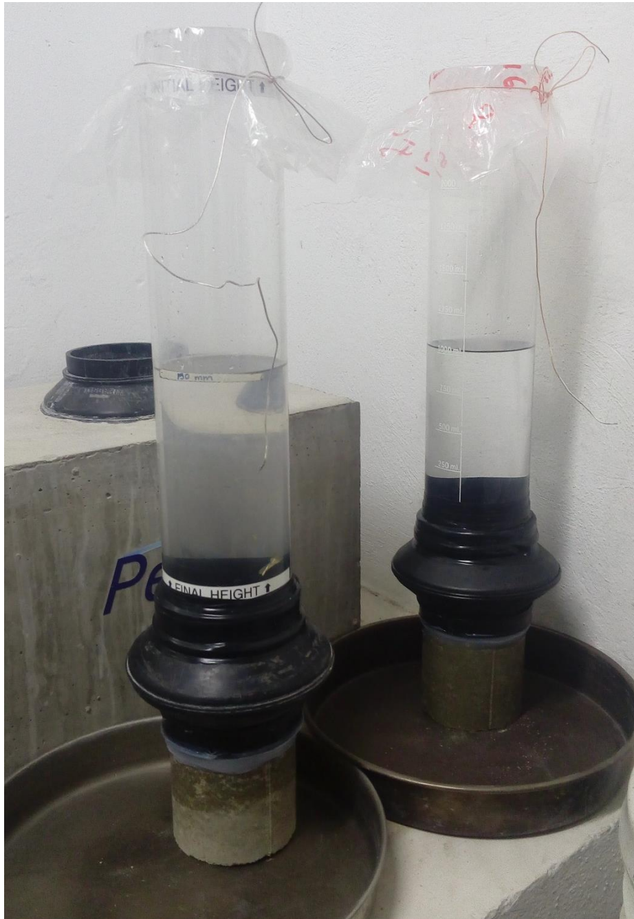
Fotografía 18 Colocación del cilindro de suelo-cemento en el dispositivo para prueba de permeabilidad. Se observa que en el espécimen de la izquierda el agua empieza a fluir a través del suelo, mientras que en el espécimen derecho el agua traspasa totalmente al suelo. (Fotografía tomada por el autor, 2016).
