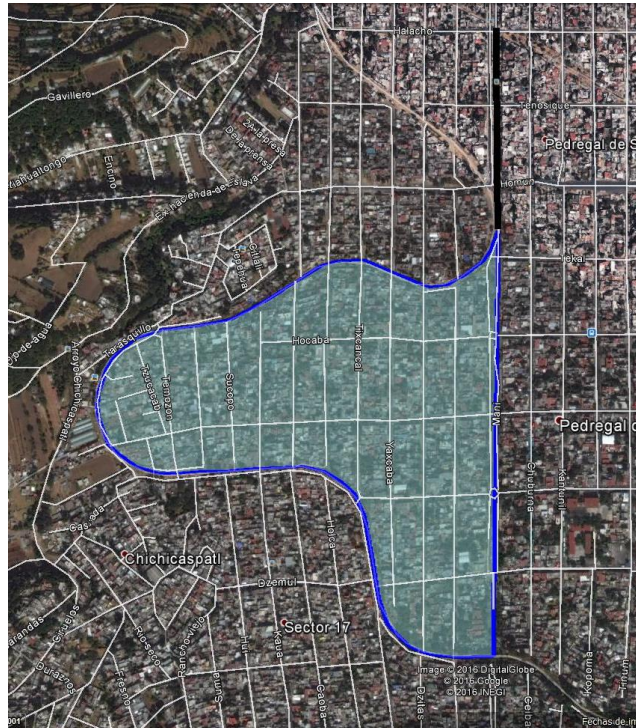
Figura 4.3.1-3 Área de aportación a la tubería secundaria 1
