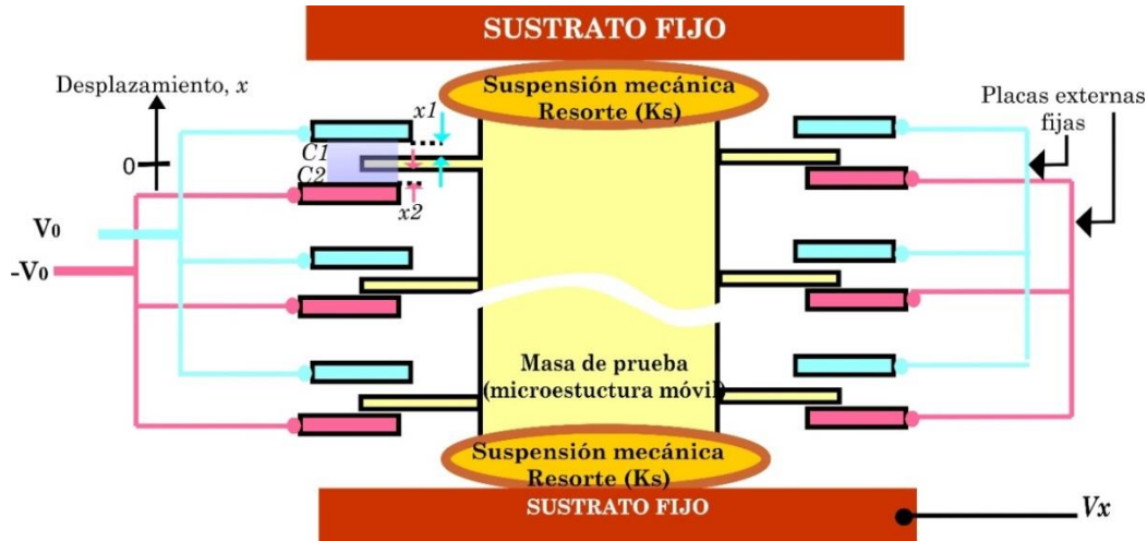
Figura 1.11. Esquema simplificado de un acelerómetro MEMS
