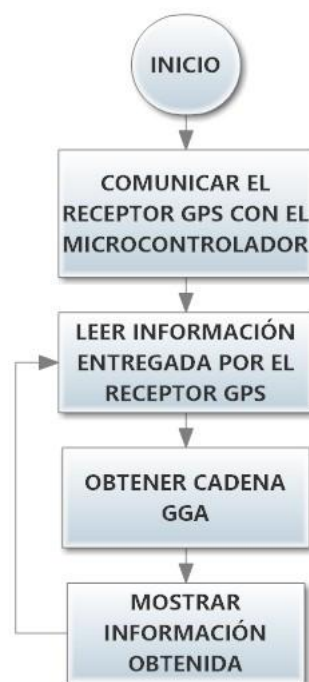
Figura 2.2. Diagrama de flujo de la primera rutina para el receptor GPS.
