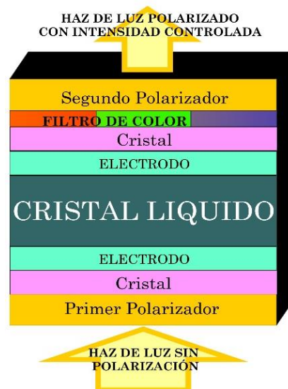
Figura 1.14. Estructura de una celda de un LCD.
